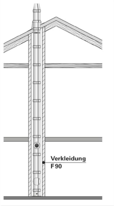
Bei Anordnung von ICS im Gebäude ist zu berücksichtigen, dass umlaufend eine durchgehende F90-Verkleidung (bis zur Dacheindeckung) angebracht werden muss.
