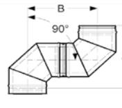
Abb. Rauchrohranschluss 45° mit Bogen 45°
